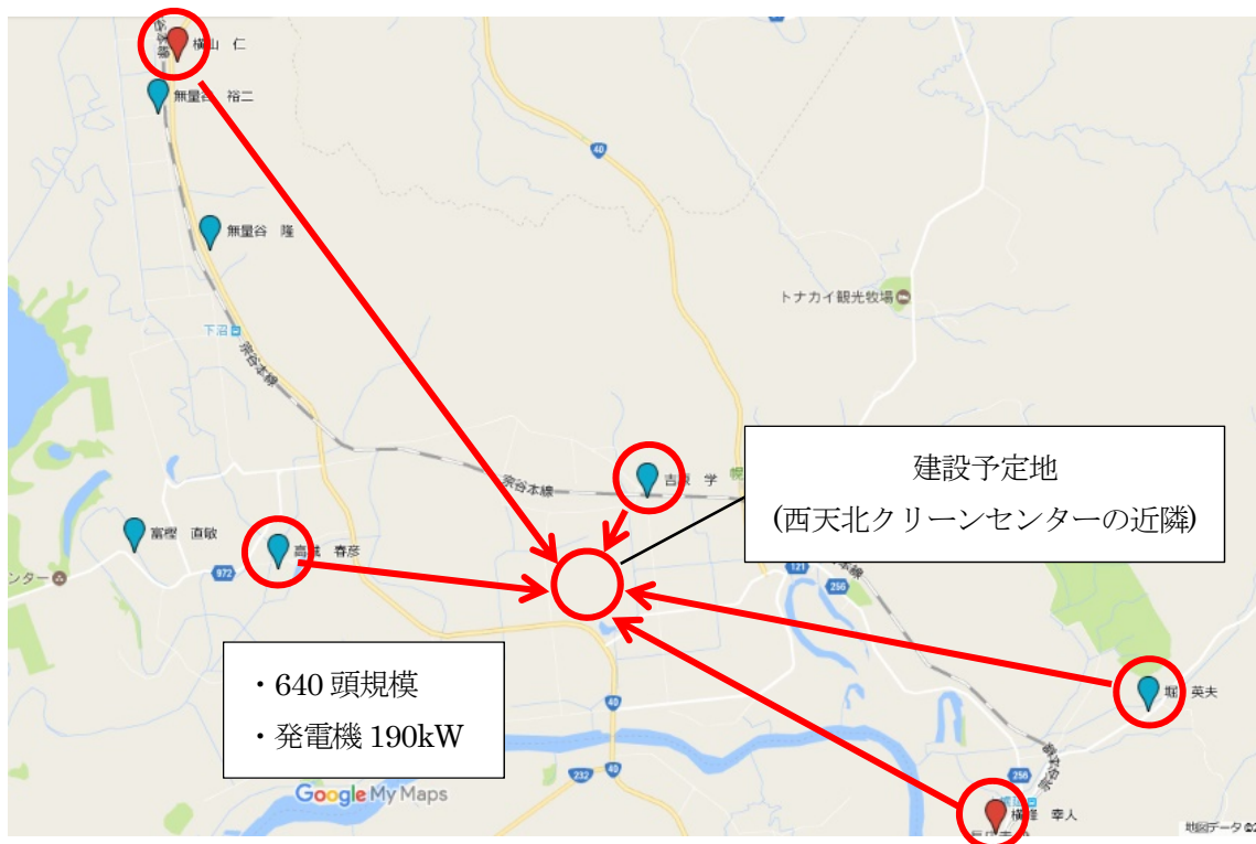
図 幌延地区における 640 頭規模集中型バイオガスプラントモデル
