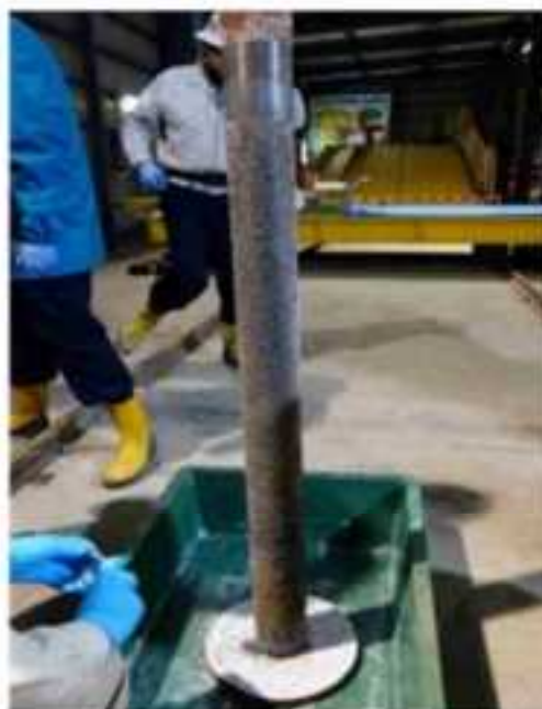
模擬オーバーバックの取り出し・腐食生成物の採取
