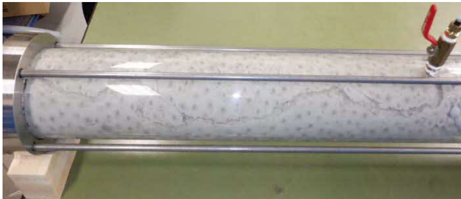
図 46 水みちの発生状況 (13)
