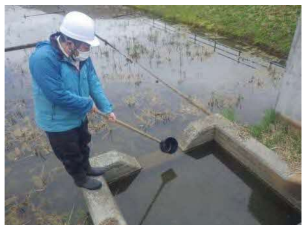
(b) 雨水調整池での採水状況
