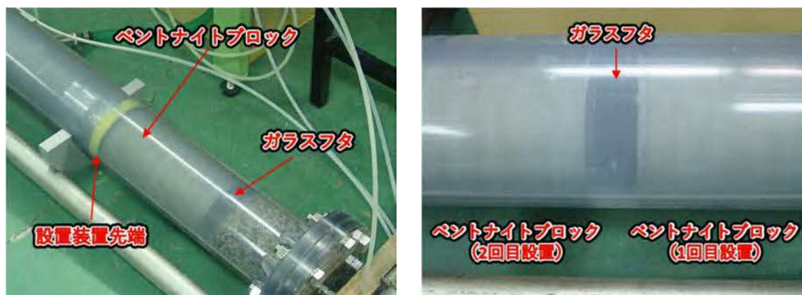
(a) ベントナイトブロックの設置状況 (b) 設置後のベントナイトブロック
