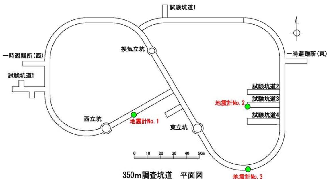
図 52 地下施設に設置した地震計
