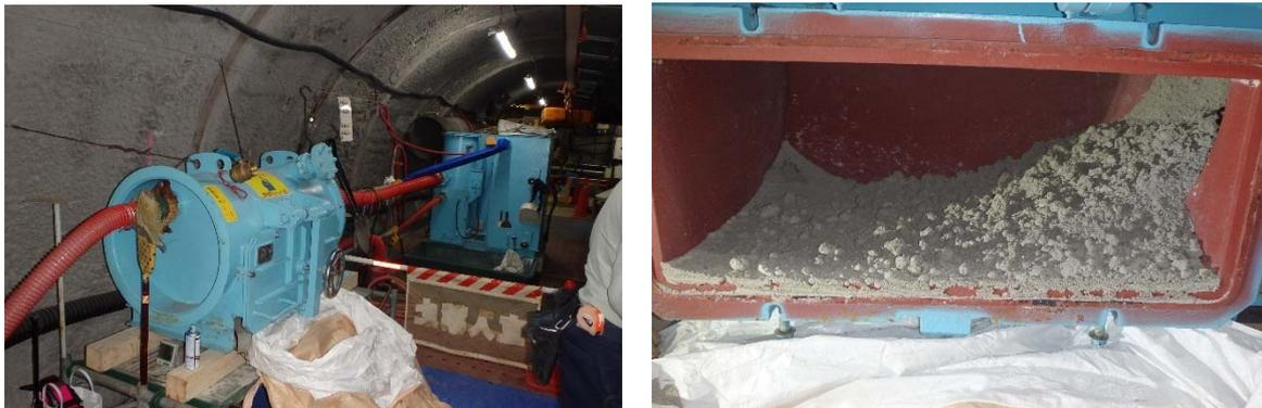
写真 5 吸引機の外観と、捕集した充填材
