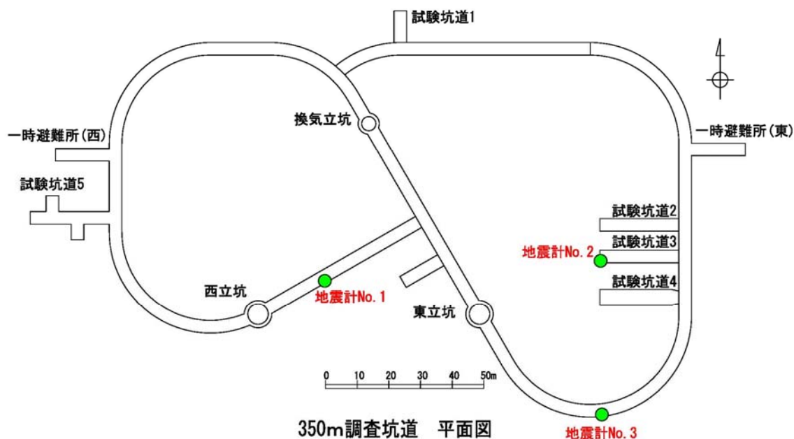
図 52 地下施設に設置した地震計
