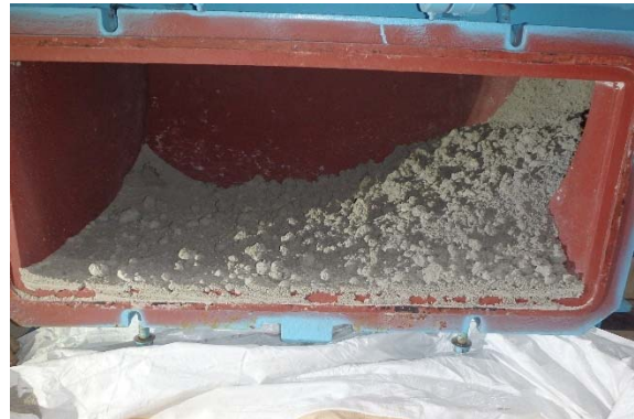
写真 5 吸引機の外観と、捕集した充填材
