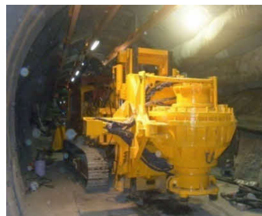
大口径掘削機
