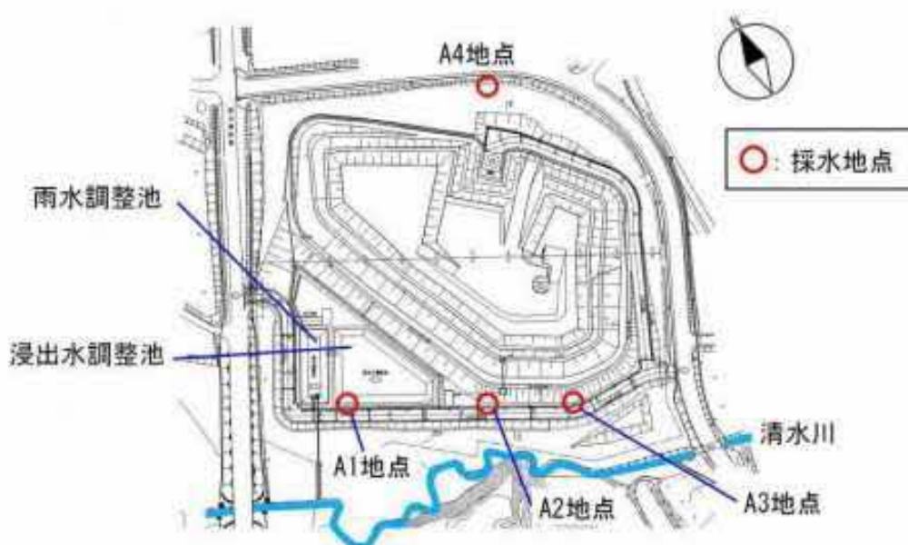
図 129 掘削土（ズリ）置場周辺の地下水の採水地点
