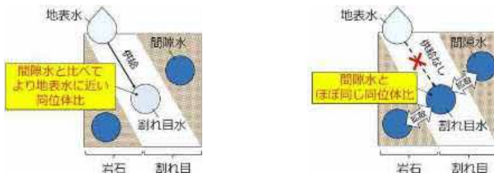
(a) 割れ目に沿って地下水の流れが生じている場 合 (b) 割れ目に沿って地下水の流れが生じていない場 合
