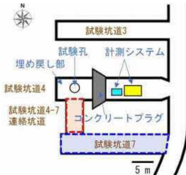
図 13 人工バリア性能確認試験の解体調査におけるアクセス用の坑道（試験坑道 4-7 連絡坑道）のイメージ図
