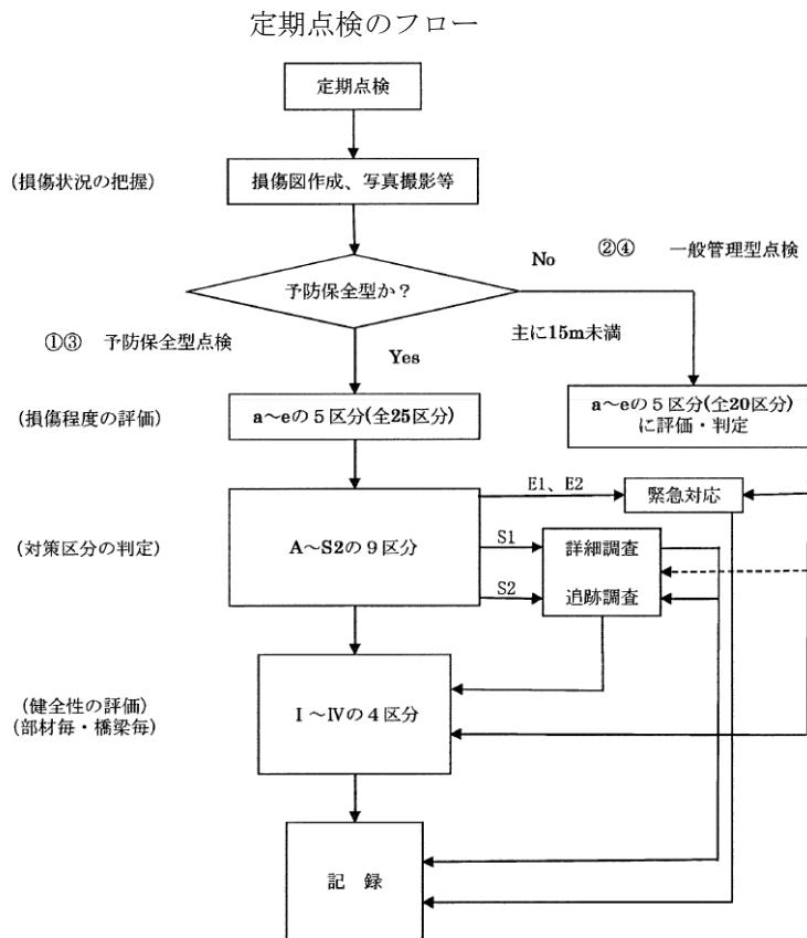
定期点検は、路線区分を閉鎖型と開放型、管理区分を予防保全型橋梁と一般管理型橋梁に区分し、点検パターン①～④（定期点検のフロー）の流れに従って行うものとします。
