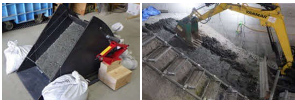
(a) 斜め撒き出し試験
