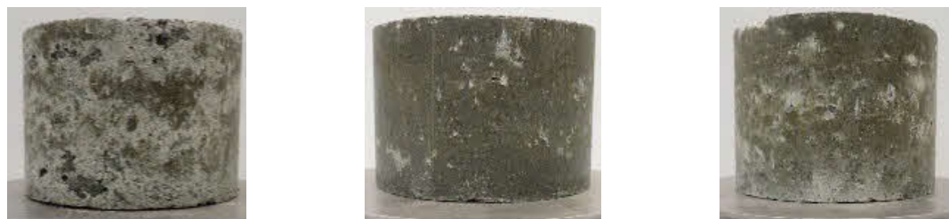
(a) ベントナイト混合率：15% (b) ベントナイト混合率：30% (c) ベントナイト混合率：40%
