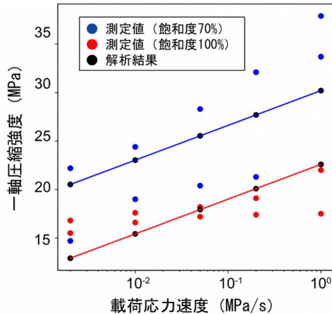
図 32 異なる飽和度の岩石試料を用いて実施した載荷速度を様々に変えた一軸圧縮試験結果
