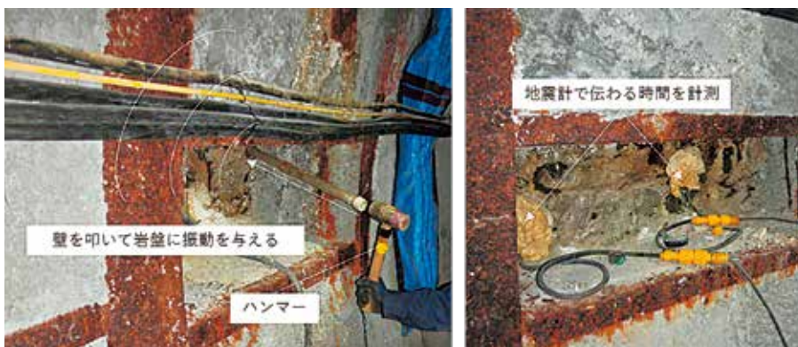
写真 ハンマーで壁を叩いて振動する波を発生させている様子（左）と、波が伝わる時間を測定している様子（右）
