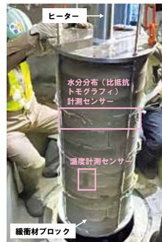
図 高温が緩衝材の特性に与える影響を検証するための原位置試験の試験体設置の様子
